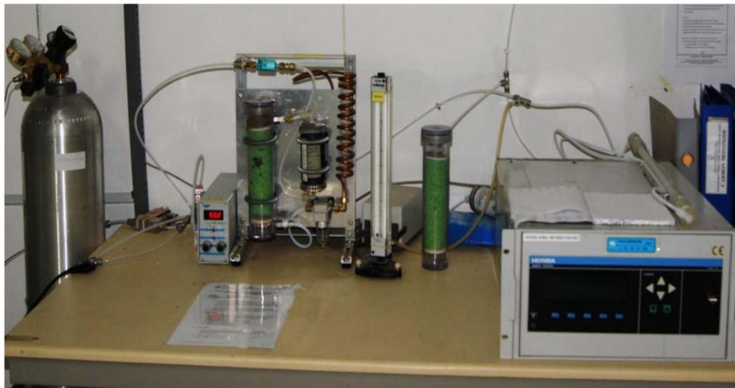
**Gambar 2.** CO Analyzer HORIBA APMA 360 dilengkapi dengan sistem kalibrasi
