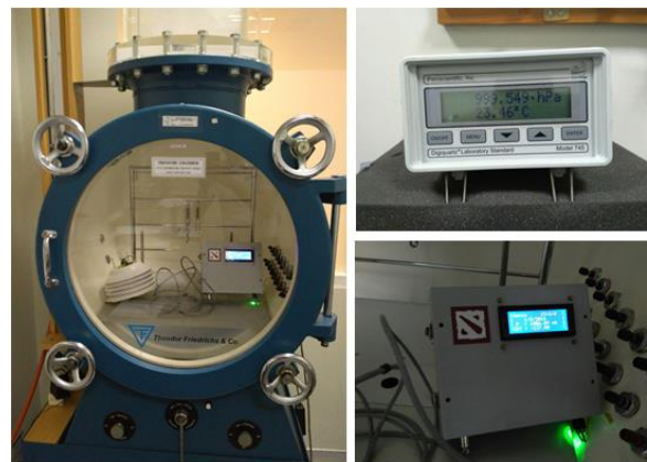
Gambar 20. Proses kalibrasi Tekanan Sensor BMP180.
