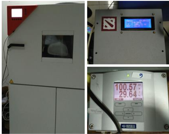
Gambar 15. Proses kalibrasi Suhu Sensor SHT11 dan DS18B20.
