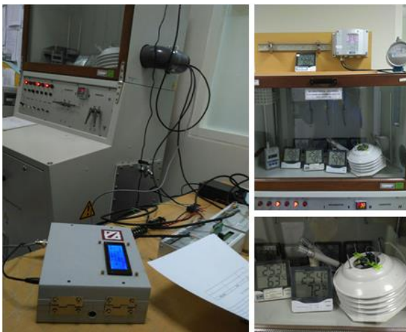
Gambar 18. Proses kalibrasi kelembaban.
